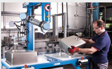
**Résultat :** Le fabricant suisse de cuisines Franke utilise un cobot UR5 pour optimiser sa production d'éviers, par un collage de précision des blocs. L'installation dotée d'un UR5 fonctionne en continu depuis novembre 2011 et produit plus de 10 000 éviers par an. Le cobot garantit l'homogénéité de la pression exercée, de la quantité de colle appliquée, et de la qualité du processus de collage dans sa globalité.
