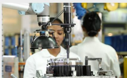
**Résultat :** Bajaj Auto Ltd (3<sup>e</sup> constructeur mondial de deux-roues) a été la première société indienne à intégrer les robots collaboratifs à une chaîne d'assemblage automobile, et utilise désormais plus de 100 cobots. La société a pu s'affranchir des contraintes d'espace grâce à des cobots fixés au plafond, et ainsi libérer les employés des tâches répétitives et impliquant de lourdes charges.
