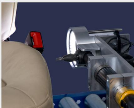
**Résultat :** Chaque jour, le bras du cobot réalise près de 8 500 actions de vissage sur des sièges auto, et surveille le processus par voie numérique afin d'éviter que des sièges défectueux ne restent sur le convoyeur. Il en résulte une production plus rapide et meilleure qualité des produits.
