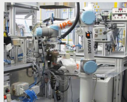
**Résultat :** Une installation de deux cobots inspecte les travaux de soudure sur plus de 160 pièces par heure, permettant à la société d'accroître sa productivité tout en atteignant ses objectifs de stabilité des coûts.
