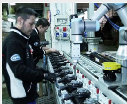
**Résultat :** RUPES a atteint son objectif de fabrication de produits à « zéro défaut » grâce au positionnement précis et au contrôle de la force, pour une conformité totale avec le cahier des charges. Les employés sont ainsi libérés des travaux éprouvants et répétitifs et peuvent se consacrer à des tâches plus gratifiantes.
